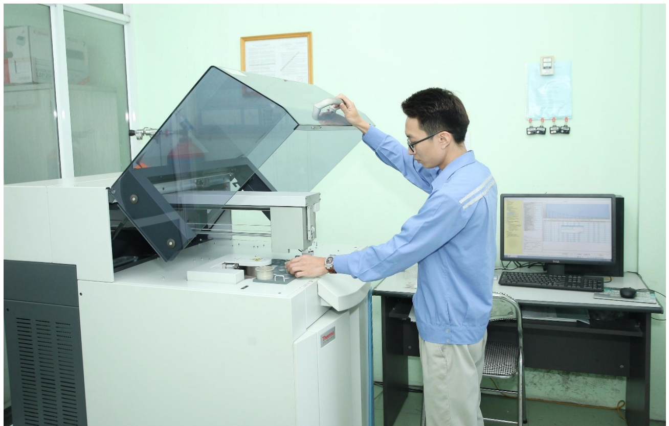
Phân tích Các thành phần oxit trên máy Quang phổ Huỳnh Quang tia X (XRF)
